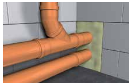
Vyplňování prostupů potrubních systémů
