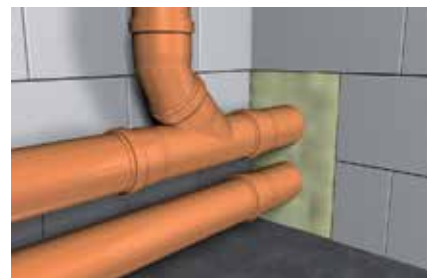
Vyplňování prostupů potrubních systémů
