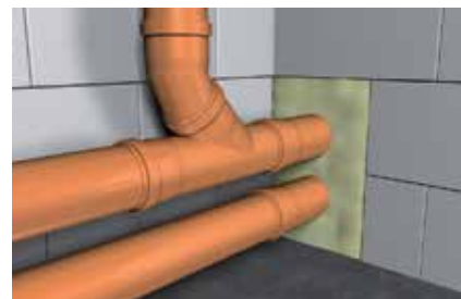
Vyplňování prostupů potrubních systémů
