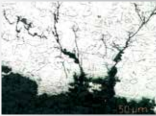
Příklad trhliny způsobené transkrystalickou korozí napětím v plechu 1.4401, který byl vystaven značně velkým účinkům chlóru..
